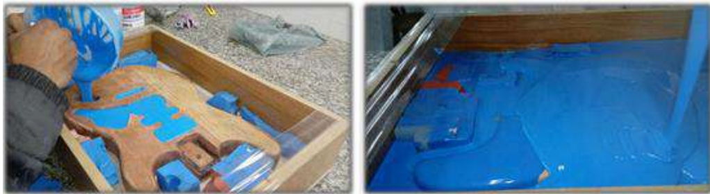
Figura 6 - Silicone sendo despejado na caixa de acondicionamento Fonte: PRÓPRIO AUTOR, 2018
