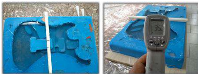
Figura 9 - Processo de cura e verificação da temperatura exotérmica da peça (Fonte: PRÓPRIO AUTOR, 2018)
