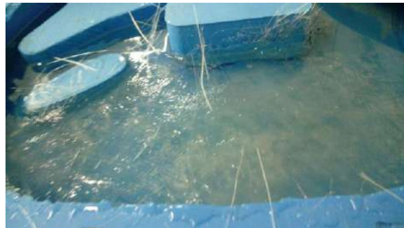
Figura 8 - Resina de poliéster, catalisador e manta de fibra de vidro (Fonte: PRÓPRIO AUTOR, 2018)
