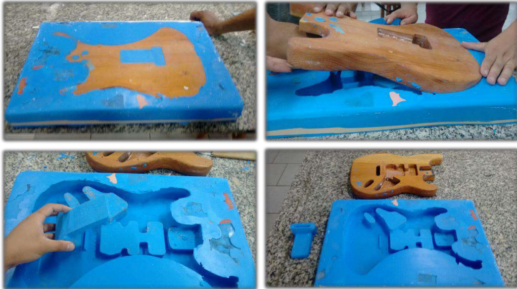
Figura 7 - Molde pronto (Fonte: PRÓPRIO AUTOR, 2018)
