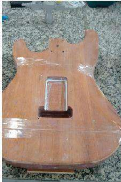
Figura 3 - Cavidade com cera desmoldante Fonte: PRÓPRIO AUTOR, 2018
