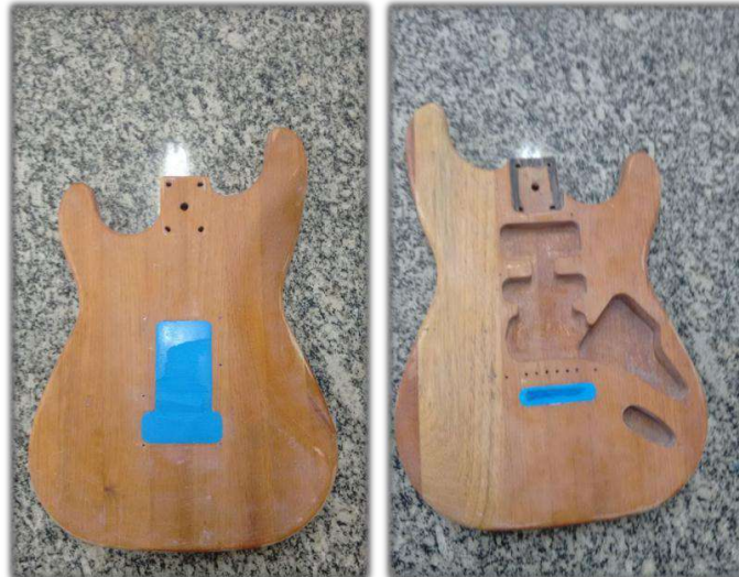
Figura 4 – Cavidade traseira do corpo da guitarra com silicone Fonte: PRÓPRIO AUTOR, 2018
