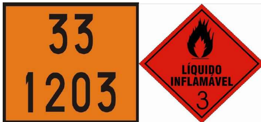
Figura 3: painel ONU e rotulo de risco
